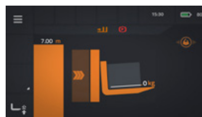
Fourches inclinées et déplacées (TDL)
