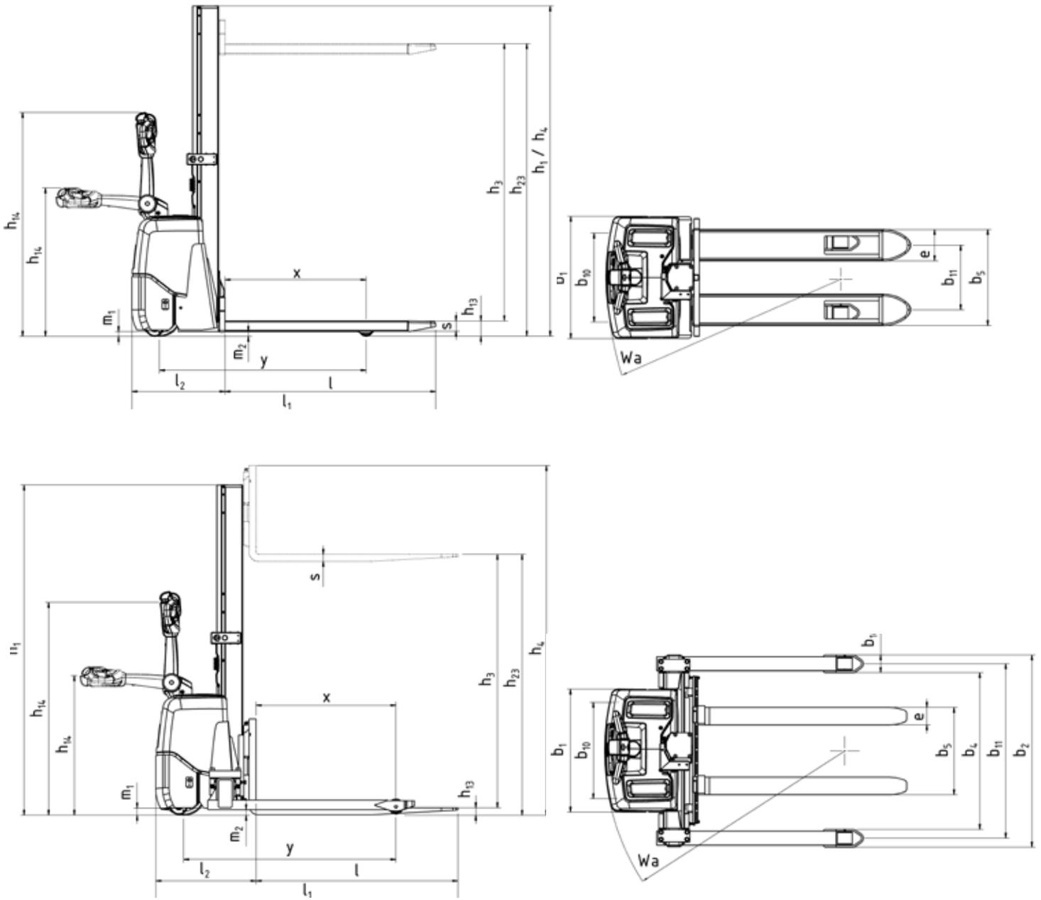
Abmessungen des Hubgerüsts
